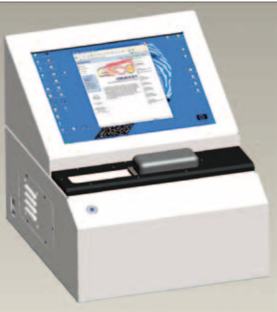
3-D-Modell des Fluoreszenzreaders mit Gehäuse
